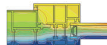
Schéma isothermique de l'intercalaire Warm Edge
